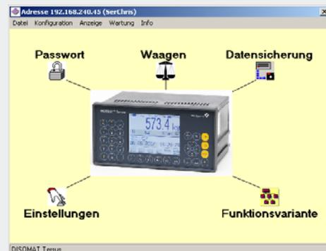
Alle Parameter- und Justagedaten werden im Gerät spannungsausfallsicher gespeichert. Die Echtzeituhr läuft mindestens 7 Tage weiter.
