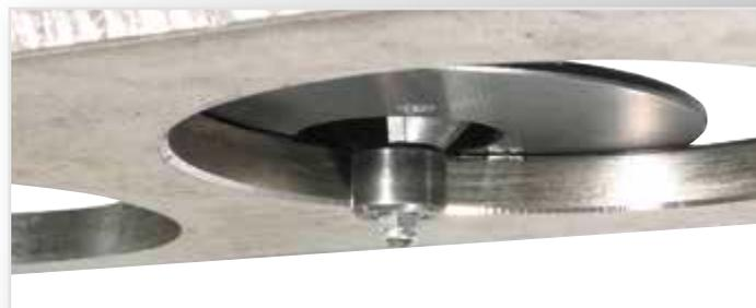
Startbohrungen ab  $\varnothing$  20 mm
