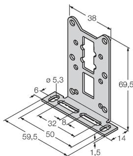
Befestigungswinkel für Quaderbauform Q14 oder Q20; Werkstoff VA 1.4301
