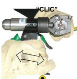
Mettre le connecteur à sertir dans la tête de sertissage entre les matrices. Fermer la tête sur le connecteur à sertir. Si besoin est, compléter le recul du piston par action sur la gâchette de décharge.
