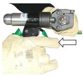
Actionner la gâchette de décharge pour obtenir le recul du piston. Ouvrir la tête pour dégager le connecteur serti.
