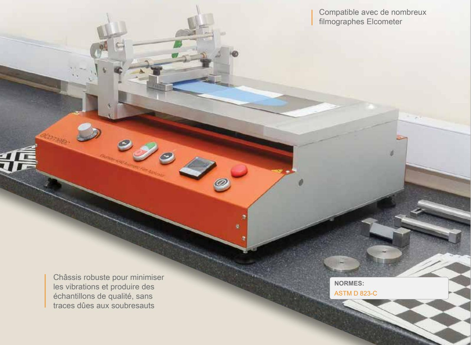
Châssis robuste pour minimiser les vibrations et produire des échantillons de qualité, sans traces dûes aux soubresauts
