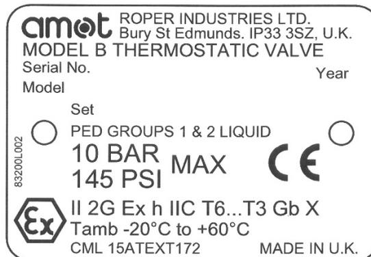
Figure 1 – B Valve Nameplate
